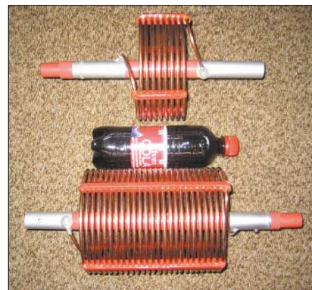
Bild 5: Luftspulen für 80 und 40 m mit einer Belastbarkeit von 1 kW PEP
