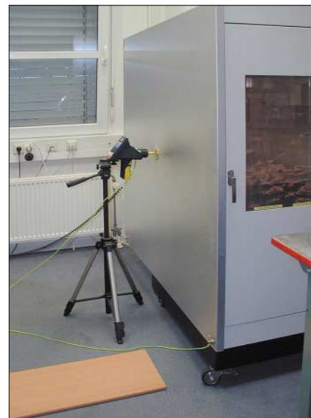
ESD-Pistolen-Kalibrierung mittels Target und Oszillograf in einem Faradayschen Käfig Werkfoto
