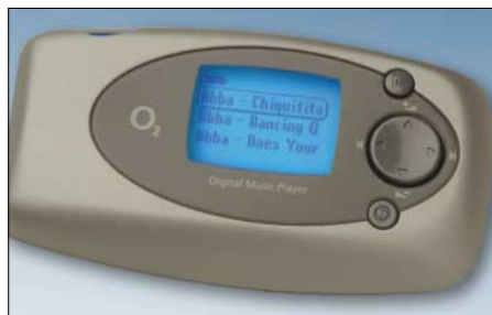
Lädt über Infrarot-Link zum Handy MP3, AAC und AAC+-Songs, kann die ersten 30 s eines Songs auch vor dem Kauf anspielen: O2 Digital Music Player Werkfoto
