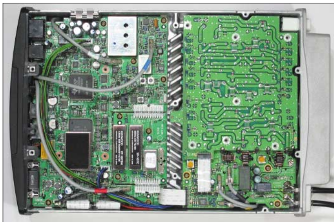
Bild 9: Blick von oben in den TS-480 (Schirmbleche abgenommen). Links unten sind hier zwei optionale ZF-Filter (1,8 kHz für SSB schmal sowie 500 Hz für CW) eingebaut; rechts daneben der Platz für einen TCXO (temperaturkompensierter Referenzoszillator). Interessant die mittigen Kühlrippen
