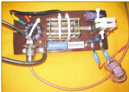
Bild 1: Schaltungsaufbau der Anpassung inklusive Servomotor
