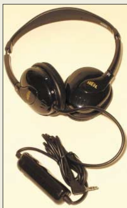
Besonders geeignet für den Einsatz in lauter Umgebung ist dieser Kopfhörer, dessen Elektronik äußere Störgeräusche unterdrückt.
